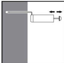
La bomba manual se utilizará para soplar orificios hasta diámetros  $d_o \leq 24\text{mm}$  y profundidades de empotramiento de  $h_{ef} \leq 10d$ . Soplar al menos 4 veces desde la parte posterior del orificio, utilizando una extensión si es necesario.
