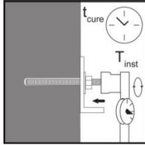
El anclaje puede cargarse después del tiempo de curado  $t_{\text{curado}}$  (ver Tabla 2).
