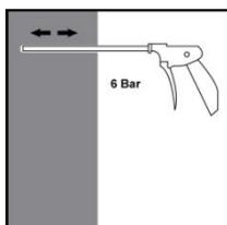
Soplar 2 veces desde la parte posterior del orificio (si es necesario con una extensión de boquilla) en toda la longitud con aire comprimido libre de aceite (6 bares como mínimo a  $6\text{ m}^3/\text{h}$ ).
