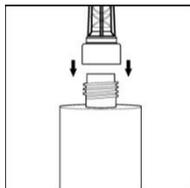
Roscar la cánula estándar o mezcladora. No modifique el mezclador de ninguna manera. Asegúrese de que el elemento mezclador se encuentra dentro de la cánula mezcladora. Utilice únicamente el mezclador suministrado.
