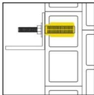
Retire el exceso de resina y deje la fijación hasta que haya transcurrido un tiempo mínimo de curado (carga).
