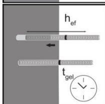
Antes de usar, verificar que la varilla roscada está seca y libre de contaminantes. Instalar la varilla roscada a la profundidad de empotramiento requerida durante el tiempo abierto de gel  $t_{gel}$  que transcurre. El tiempo de trabajo  $t_{gel}$  se proporciona en la Tabla 2.
